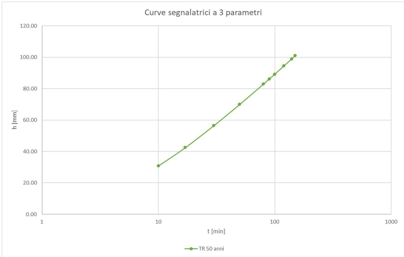
Figura 2.7: Curva di possibilità pluviometrica caratteristica dell'area di studio
